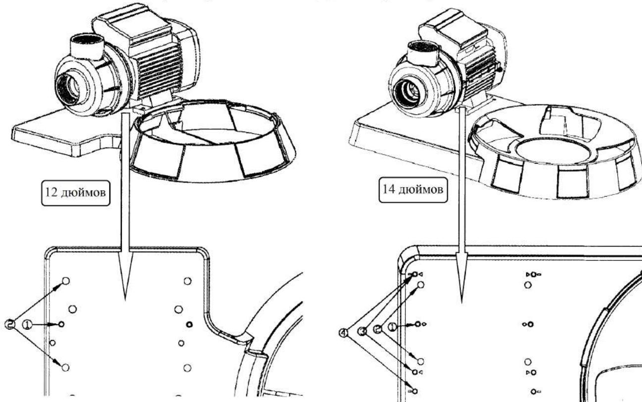
Монтажные отверстия для 12 дюймового песочного фильтра:
