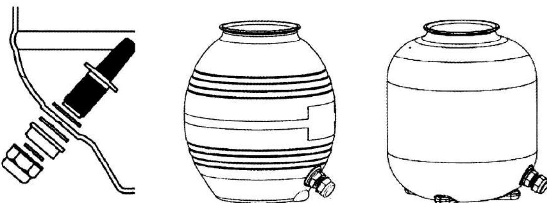
3. Для фиксации бака установите его на подставку фильтра, нажмите и поверните, предварительно скорректировав его положение (сливная пробка должна оказаться снаружи, как это показано на рисунке ниже).
