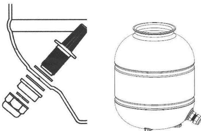
3. Для фиксации бака, установите его ножкой с пазом в посадочное место на подставке и нажмите на него. Сливная пробка должна оказаться снаружи, как это показано на рисунке ниже.
