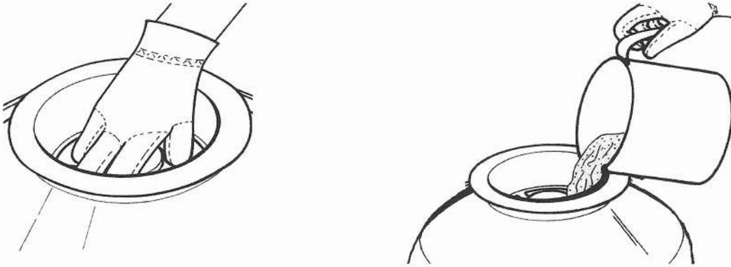
5. Уберите шаблон, и убедитесь, в том, что горловина бака осталась чистой. Наденьте на клапан уплотнительное кольцо и при помощи зажимного фланца зафиксируйте на баке фильтра (порт клапана с меткой "PUMP" должен быть повернут к выходному порту насоса).
